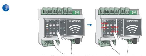
Pulse el botón forzado ON del relé a codificar con el emisor de esa zona, hasta que parpadeen el LED de zona y el de codificación
