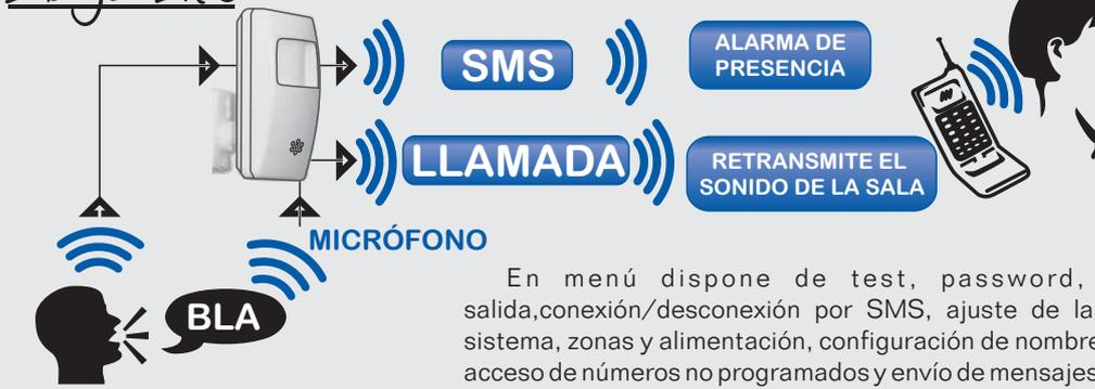
El Logo IR es un sensor de infrarrojos con aviso por SMS y micrófono integrado con el cual podrá, garantizar la seguridad de una propiedad, Monitorizar el estado de la alimentación 230V a través de mensajes SMS y escuchar de forma remota lo que está sucediendo gracias al micrófono incorporado.
